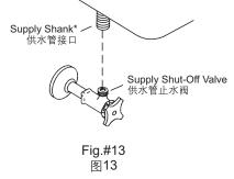
\*我们建议使用软管(不随货供应)来连接 供水管与座便器进水阀。如果您使用硬 管(不随货供应)连接的话,连接时要注 意不要在进水阀的底部施加横向压力, 并请注意硬管必须与供阀口完全吻合, 以免强行连接日后会损坏接口。 **IMPORTANT:** Before turning on the supply valve for the first time, follow the steps below to clear sand, debris and rust from the system:
