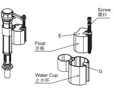
Fig.#16e 图16e 浮桶调节注意事项:调节螺杆时保证 E面下沉于G面2-4mm。
